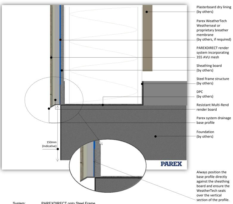
System: PAREXDIRECT onto Steel Frame
