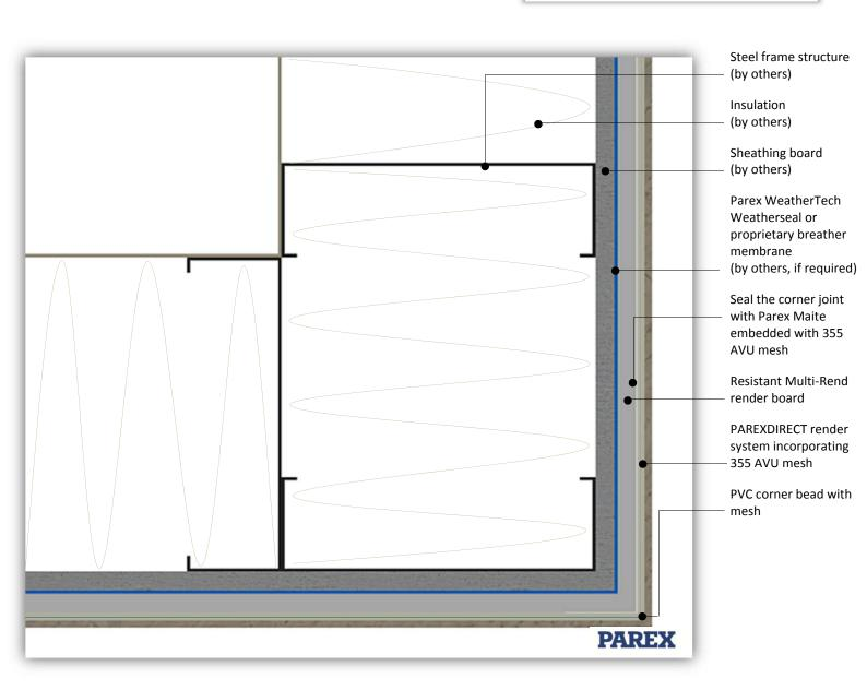
System: PAREXDIRECT onto Steel Frame
