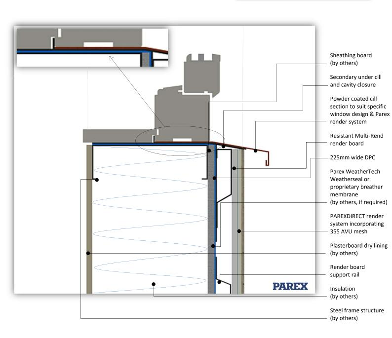
System: PAREXDIRECT onto Steel Frame
