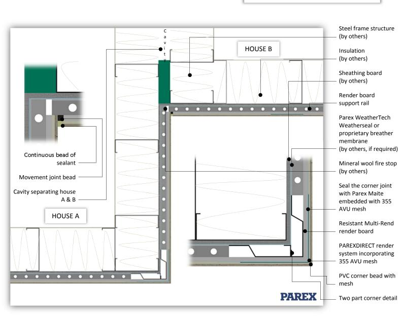
System: PAREXDIRECT onto Steel Frame
