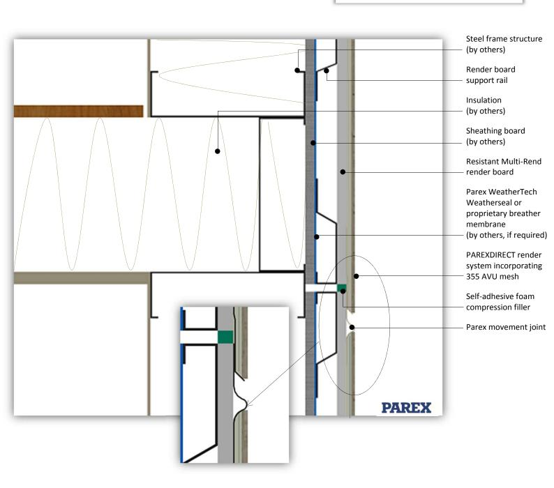
System: PAREXDIRECT onto Steel Frame
