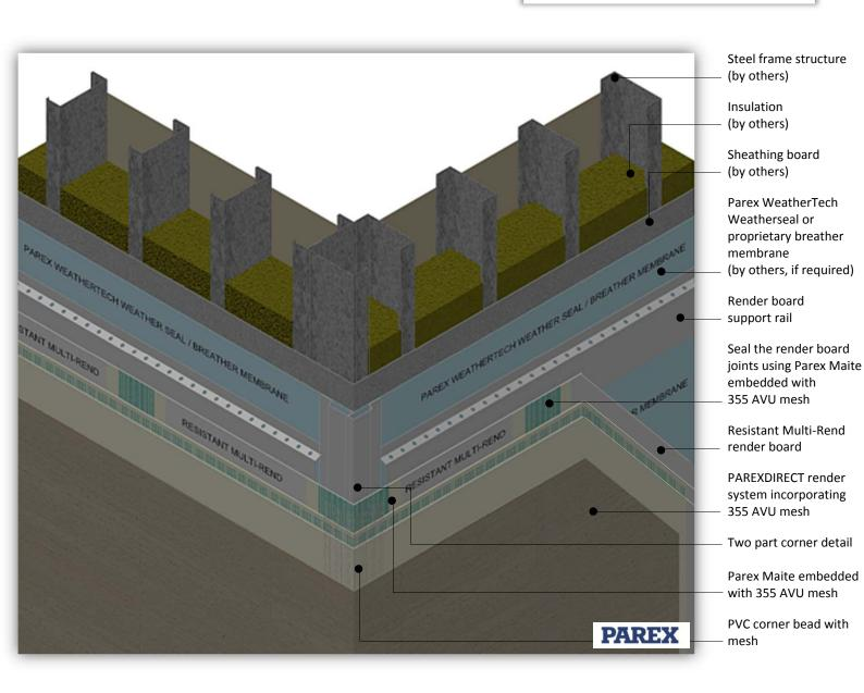
System: PAREXDIRECT onto Steel Frame
